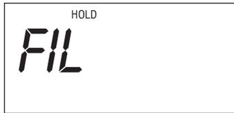
1. Maintenir la touche **SHIFT/RESET** puis appuyer sur **FILTER** (filtre). Le compresseur démarre et l'affichage indique « FIL » et « AUTOMATIC ».
