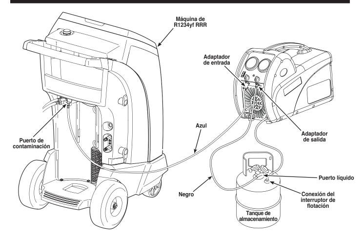
El 25700 está específicamente diseñado para recuperar refrigerante contaminado de la máquina R1234yf RRR o de un vehículo contaminado. Para recibir instrucciones e información específicas en la identificación y recuperación de tal refrigerante dentro del R1234yf RRR, consulte el manual del usuario del R1234yf RRR.
